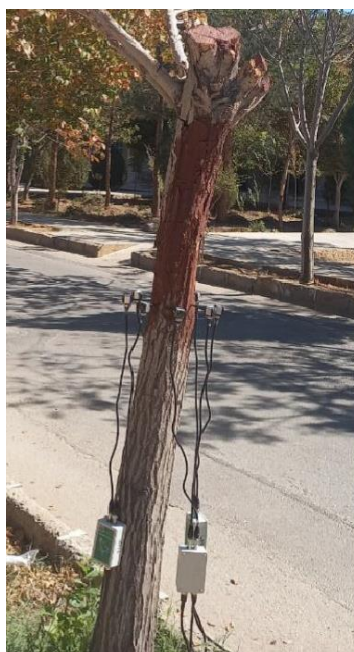
شکل ۳- دستگاه برش‌نگاری درختان سرپا و نحوه اتصال آن به تنه درخت
