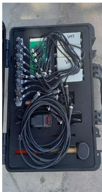
شکل ۳- دستگاه برش‌نگاری درختان سرپا و نحوه اتصال آن به تنه درخت
