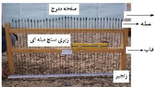
شکل ۳. نحوه اندازه‌گیری زاویه باد پناهی با استفاده از زبری سنج میله‌ای.
