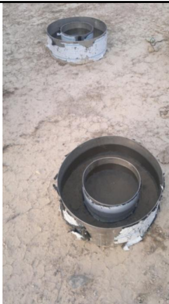
شکل ۵- اندازه‌گیری نفوذپذیری با استفاده از حلقه مضاعف
